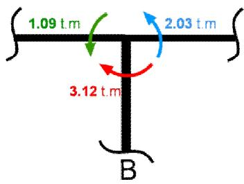
برش مقابل از ستون B و تیرهای متصل به آن را در نظر بگیرید لنگر ستون برابر 3.12 t.m و لنگر تیر متصل به آن در سمت چپ همانگونه که در بالا حساب شد برابر 1.09 t.m می باشد طبق همان فرض اصولی باید مجموع لنگر ستون و تیرها در گره برابر صفر باشد پس لنگر تیر سمت راست به صورت زیر به دست  $M = 3.12 - 1.09 = 2.03 \text{ t.m}$  می آید .
