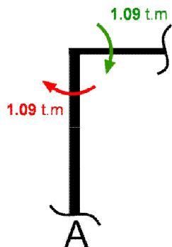
این برش ساده از ستون A در طبقه چهارم و تیر متصل به آن را در نظر بگیرید طبق فرضهای اولیه ای که برای تحلیل پرتال ذکر شد در هر گره باید مجموع لنگر ستونها برابر با مجموع لنگر تیرها باشد لنگر ستون در این مورد برابر 1.09 t.m می باشد پس برای تیر متصل به آن به همین مقدار لنگر با علامت منفی می رسیم .
